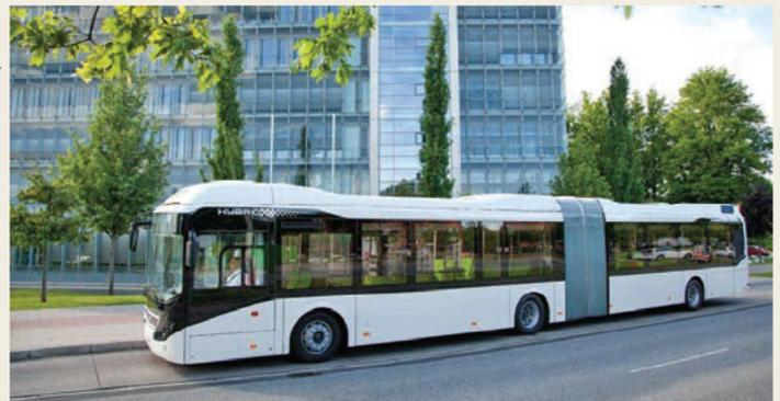
barque de passageiros, o novo articulado opera 70% no modo elétrico e 30% no modo híbrido. Isso permite uma redução de até 75% no consumo de combustível e de emissões de CO<sub>2</sub>, em relação ao ônibus convencional movido a diesel, segundo testes iniciais.
