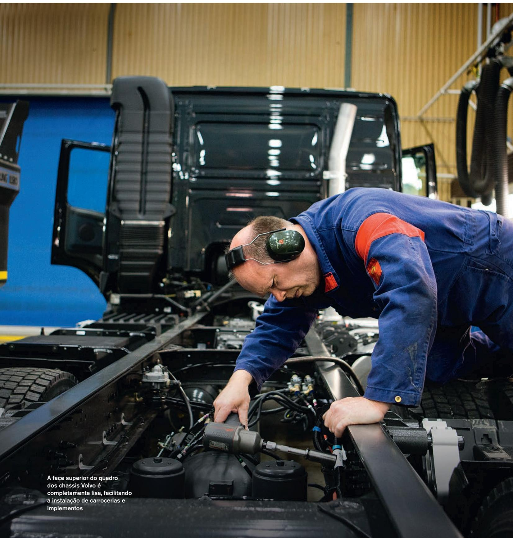
A face superior do quadro dos chassis Volvo é completamente lisa, facilitando a instalação de carrocerias e implementos
