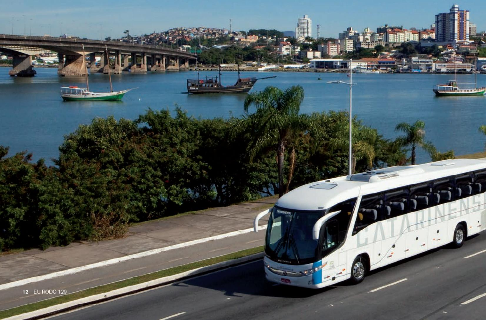
**Os veículos.** Todos os 310 ônibus são do modelo B340R versão 4x2, com motor de 330 cv de potência. O B340R é equipado de série com o sistema de freios inteligentes ABS/EBS, que aumenta a segurança nas frenagens e evita que o veículo patine, e com o freio motor Volvo com 390 cv de potência, mais seguro nas descidas.
