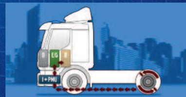
Durante a frenagem, a energia é recuperada e aplicada às baterias pelo motor elétrico, que agora age como gerador.
