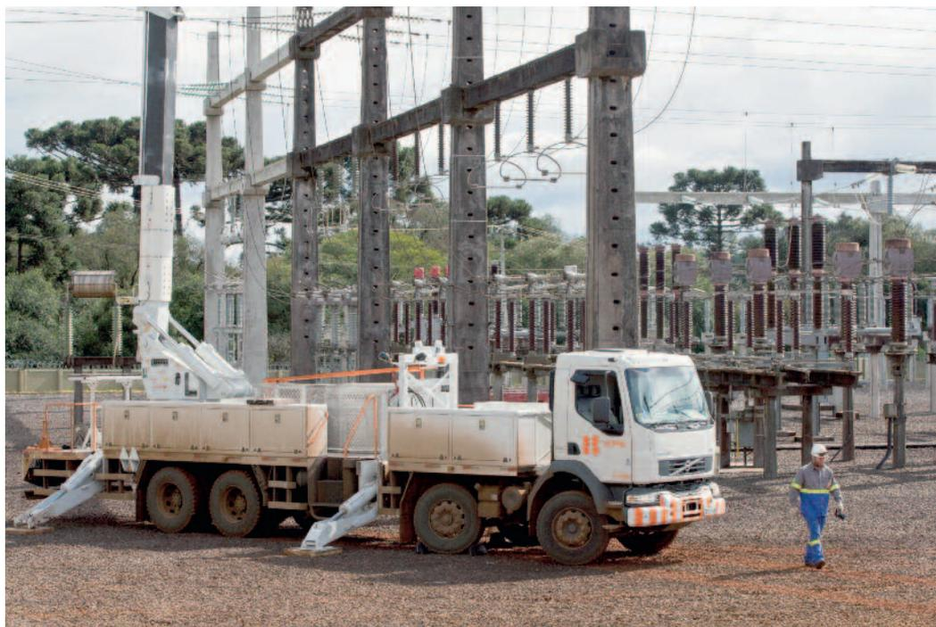
Para que o cesto seja elevado, é preciso primeiro que sejam abertas quatro sapatas, que vão garantir a estabilidade do caminhão. O entre-eixos do VM foi preparado e um eixo direcional adicional foi incluído para carregar o peso do equipamento. Após todas as adaptações e testes, o caminhão foi testado no Lactec, em Curitiba, seguindo a Norma Brasileira NBR 16092, que trata de “Cestas Aéreas – Especificações e Ensaios”.
