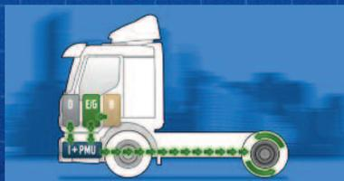
Em velocidades mais altas, o motor a diesel é ativado e os dois motores trabalham paralelamente. O I-Shift e a Powertrain Management Unit otimizam automaticamente o uso para economia de combustível.
