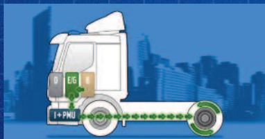
Ao arrancar e até velocidades de 20 km/h, o sistema de transmissão é acionado pelo motor elétrico, usando energia das baterias.
