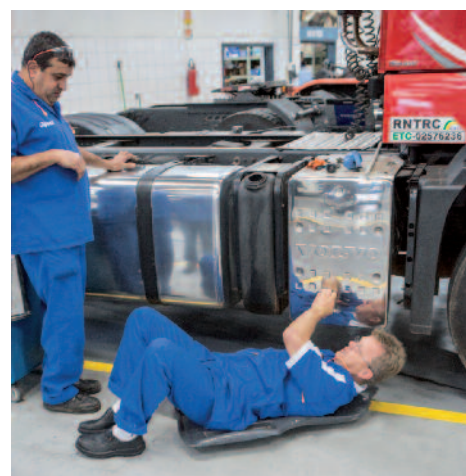
Desmontagem de um componente exigiu trabalho embaixo do caminhão, com carrinho e ferramentas especiais
