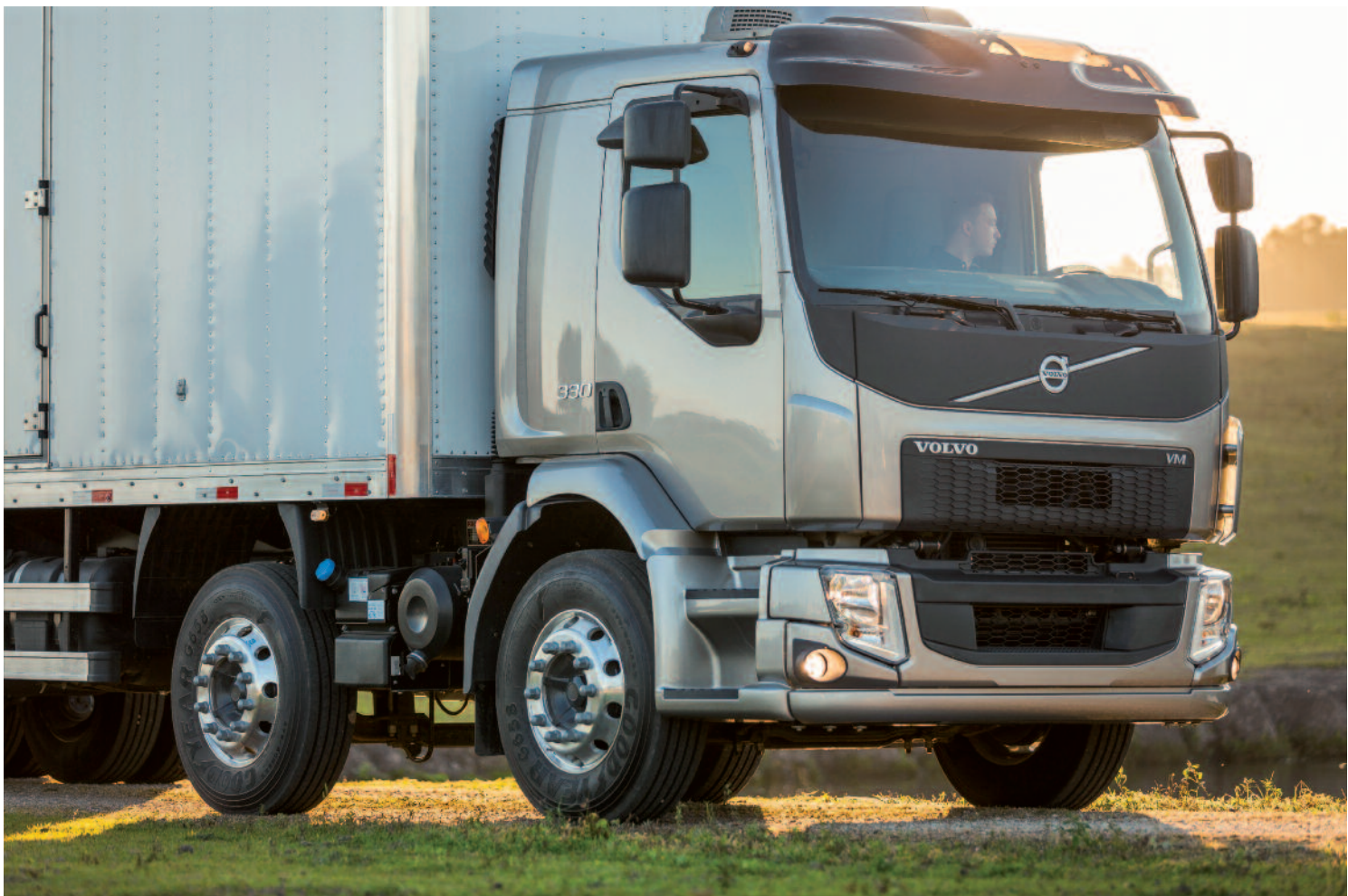
Novas versões 8x2 e 8x4 têm eixos dianteiros direcionais, com sensor automático de carregamento
