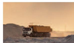
**Volvo FMX 6x4**, trator projetado para cargas pesadas, motor D13 Euro 3 de 400 cv.
