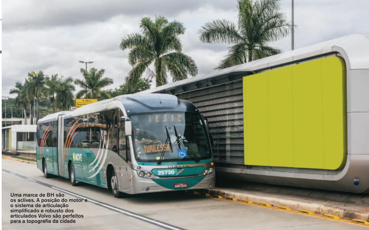
Uma marca de BH são os aclives. A posição do motor e o sistema de articulação simplificado e robusto dos articulados Volvo são perfeitos para a topografia da cidade
