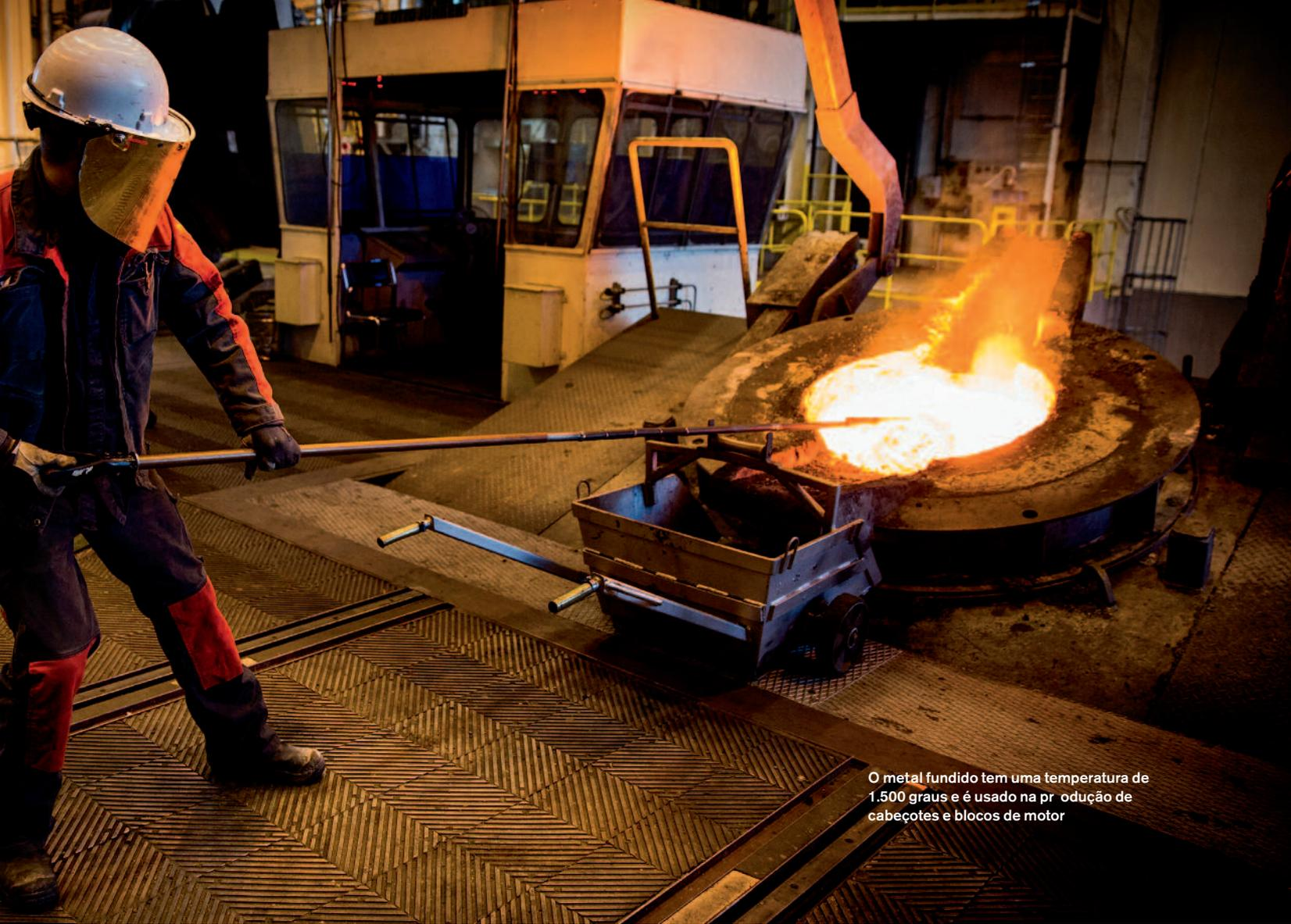
O metal fundido tem uma temperatura de 1.500 graus e é usado na produção de cabeçotes e blocos de motor
