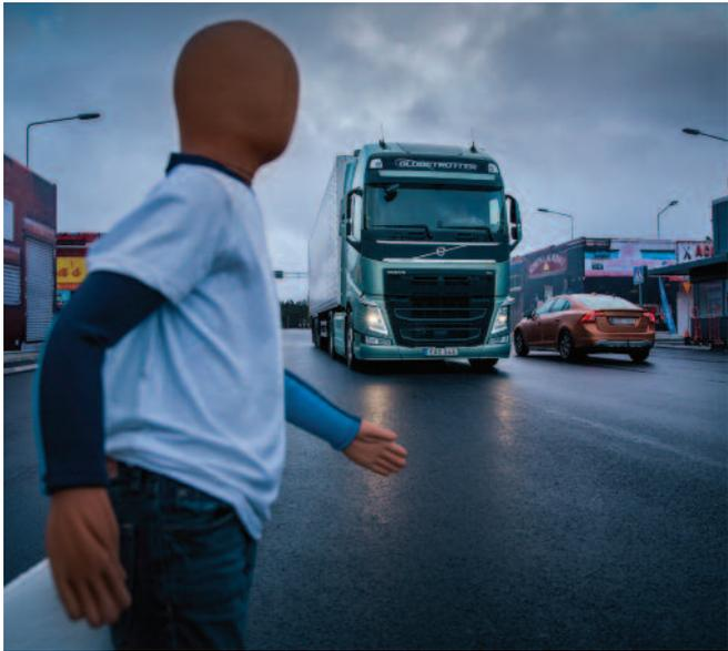
O AstaZero é a primeiro ambiente de testes do mundo em escala real para a segurança ativa. Aqui, caminhões Volvo são testados utilizando bonecos e outros veículos em condições próximas da real.
