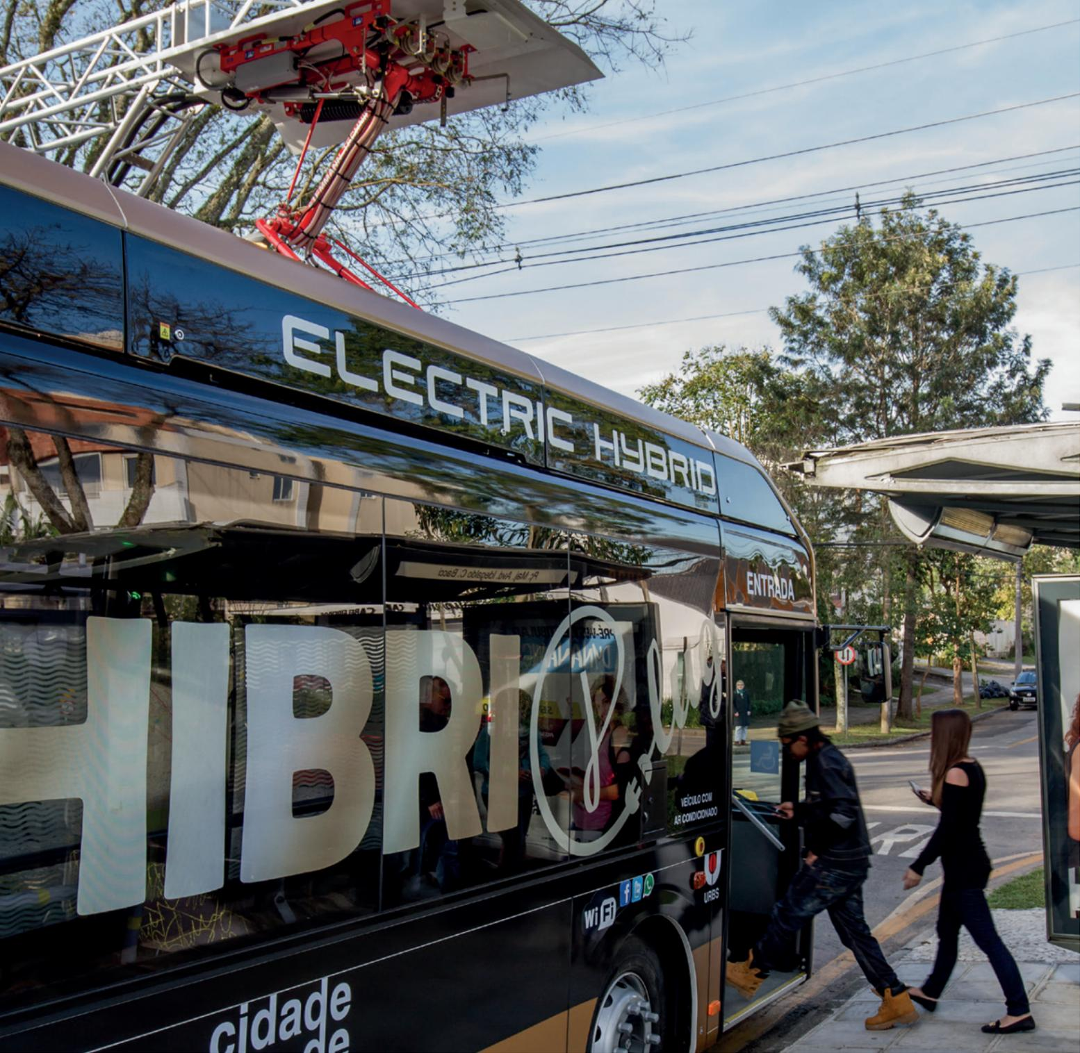
Seis minutos. É o tempo de parada de ônibus em uma estação central. Um tempo breve, mas com impacto muito grande em qualidade de vida e mobilidade urbana: bastam, no máximo, seis minutos de recarga de suas baterias, e o ônibus elétrico-híbrido da Volvo está pronto para provar que consome 62% menos diesel, oferecendo uma operação mais silenciosa e confortável.
