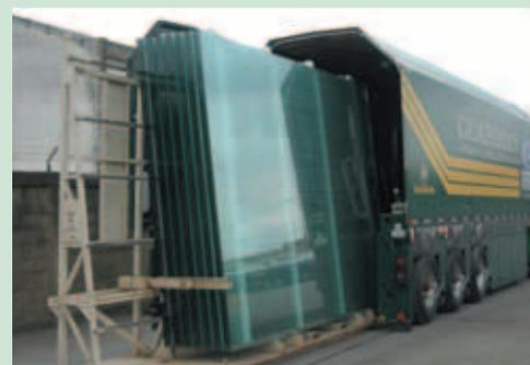
Carreta especial com suspensão a ar e funcionários treinados na Alemanha garantem o transporte seguro de lâminas de vidro de até nove metros de comprimento
