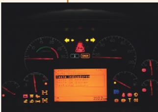
O sistema de Proteção Estendida do Motor monitora fatores como a pressão e a temperatura do óleo do motor, aproveitando a eletrônica embarcada dos caminhões Volvo
