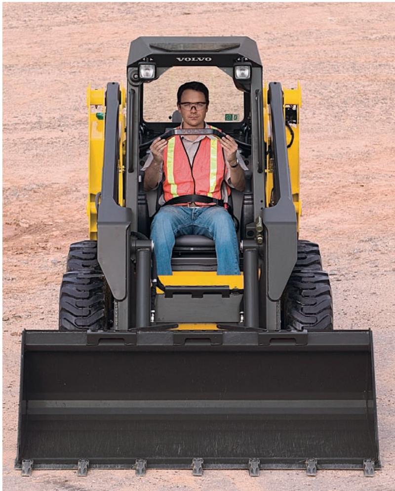
para proporcionar excelente visibilidade. As janelas laterais são facilmente removíveis para limpeza e o cinto de segurança de três pontos mantém o operador seguro no assento.
