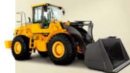
L105 är en medeltung hjullastare från Volvo Construction Equipment. Den är framtagen speciellt för att möta behoven från kunder i Kina och andra tillväxtmarknader.
